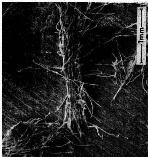
Rys. 2. Zanieczyszczenia — ścinki pochodzące z linii strefowych zgnilizny mają przeważnie kształt wydłużony. Wiązka włókien jest często złączona fragmentem promienia rdzeniowego
